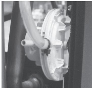
**Pressão fumos:** controla a queda de pressão no conduto de fumo. Está desenhado para fechar o parafuso de alimentação de pellets se houver uma obstrução na tiragem da chaminé ou uma pressão de retorno importante (exemplo por causa do vento). No momento do pressão irá mostrar “ALAR-DEP-FAIL”.
