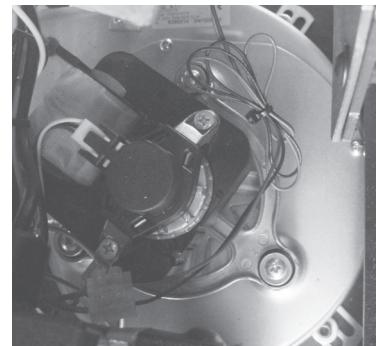
**Sonde température fumées:** ce thermocouple relève la température des fumées et fait partir ou arrête le poêle lorsque la température des fumées descend au-dessous de la valeur programmée.
