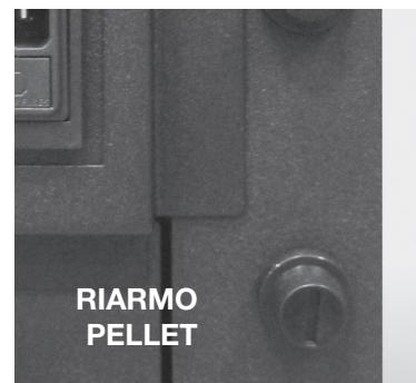
**Dispositif de sécurité température des granulés de bois:** si une température excessive se vérifiait à l'intérieur du réservoir, le thermostat de sécurité des granulés de bois à réarmement manuel générera une alarme "**ALAR-SIC-FAIL**". pour interrompre le fonctionnement de le poêle. Le rétablissement doit être effectué par le client en réarmant ce dispositif placé derrière l'appareil.
