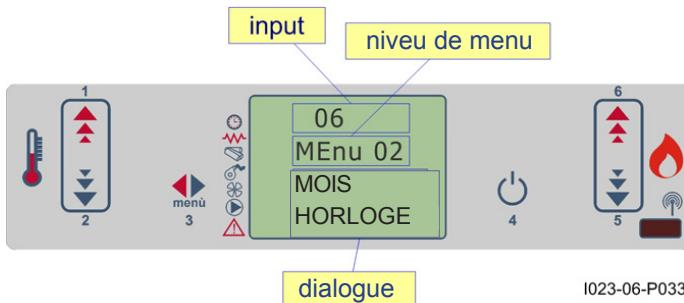
Réglez l'heure et la date. La carte est dotée d'une batterie lithium qui permet à l'horloge interne une autonomie supérieure à 3/5 ans.
