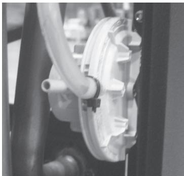
**Presostato:** controla la presión del conducto de humos. Se ocupa de bloquear la cóclea de carga de las pellas en caso de que la descarga esté obstruida o de que haya contrapresiones significativas por ejemplo en presencia de viento. En el momento del interruptor de presión va a leer “ALAR-DEP-FAIL”.
