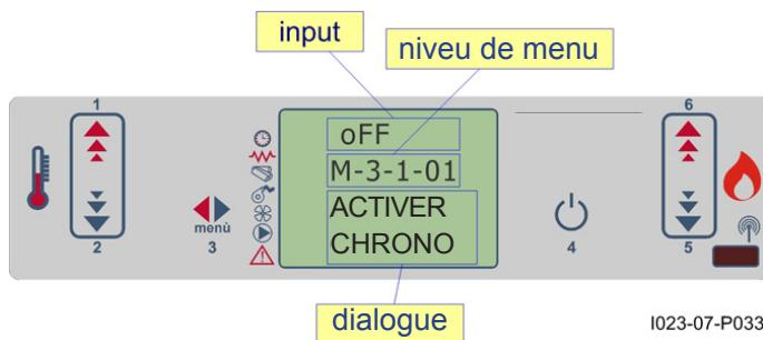
Le programmeur hebdomadaire dispose de 4 programmes autonomes dont l'effet final est composé de la combinaison de chacune des 4 programmations. Le programmeur hebdomadaire peut être activé ou désactivé. En outre, en réglant sur OFF dans le champ horaires, l'horloge ignore la commande correspondante.
