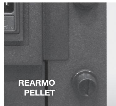
**Seguridad temperatura del depósito pellets:** en casos rarísimos en los que se verifica una temperatura excesiva en el interior del depósito, el termostato de seguridad de pellets, en la puesta en marcha manual, genera una alarma “ALAR-SIC-FAIL” interrumpiendo el funcionamiento de la estufa, el restablecimiento debe de ser efectuado por parte del cliente, quien restaura dicho dispositivo colocado en la parte posterior de la estufa
