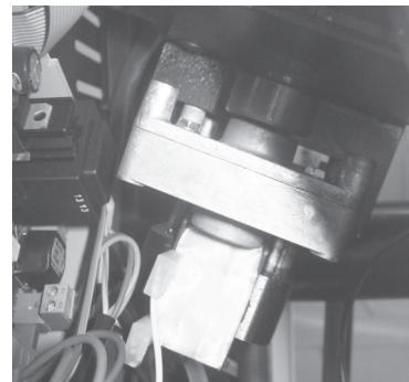
**Motor de redução:** se il motorduttore se pára, a estufa continua a funcionar até que a chama se apague por falta de combustível e até atingir o nível mínimo de arrefecimento.
