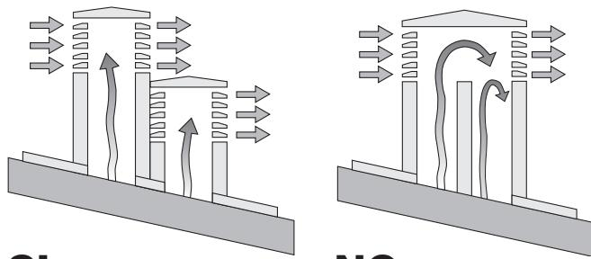
Fig. 5: características de la tapa de la chimenea
