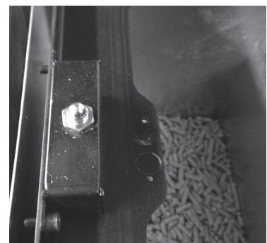
**Microswitch porte pellet:** ouvrir la charge de porte poêle à granulés hors tension de la pastille et il reste ouvert pendant plus de 120 "pour désactiver le chauffage de l'erreur "**ALAR-DEP-FAIL**".
