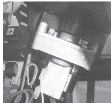
**Motoriduttore:** se il motoriduttore si ferma, la stufa continua a funzionare fino a quando non si spegne la fiamma per mancanza di combustibile e fino a che non raggiunge il livello minimo di raffreddamento.
