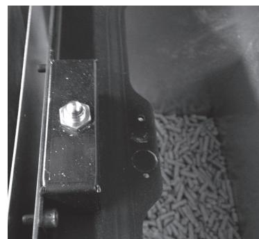
**Microinterruptor puerta pellet:** cuando se abre la puerta cargo pellet la estufa interrumpe la alimentación del pellet y permanece abierta durante más de 120 ”, desconecta el aparato para el error “ALAR-DEP-FAIL”.
