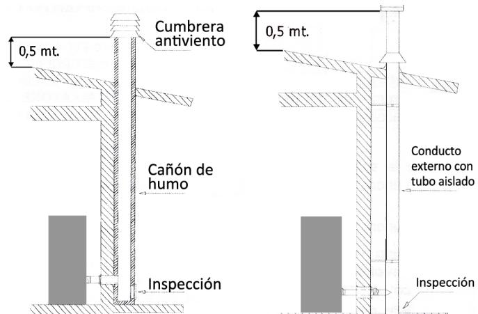
Fig. 2: conexión con el cañón de humo
