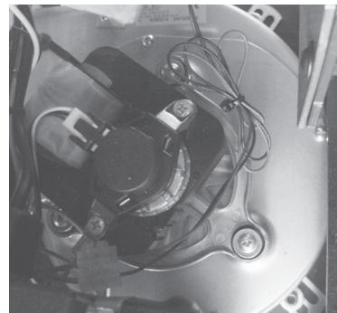
**Sensor temperatura humos:** termopar que mide la temperatura de los humos mientras se mantiene el funcionamiento o apaga la estufa cuando la temperatura del gas de combustión cae por debajo del valor preestablecido.
