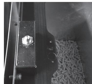
**Microcomutador porta do pellet:** quando você abre o porta do pellet o fogão interrompe a alimentação dos pellet e se ele permanece aberto por mais de 120" o estufa se desliga para o erro “ALAR-DEP-FAIL”.
