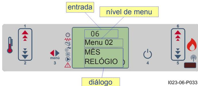
Definir a hora ea data. A placa electrónica está equipado com uma bateria de lítio que permite o relógio interno uma autonomia sobre 3/5 anos.
